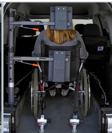
Das Fahrzeug kann optional mit der Kopf- & Rückenstütze **FUTURESAFE** ausgestattet werden.
